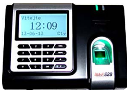
Terminál BM-F628 - otisk, heslo, příchod, odchod, 1 absence, hlasový výstup
