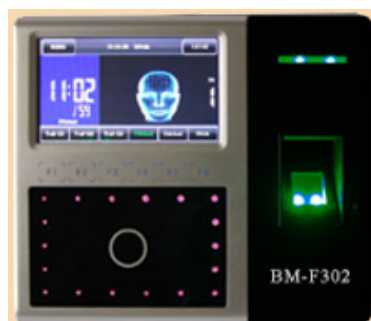
Terminál BM-F302 – obraz tváře, otisk, karta, příchod, odchod, 20 kódů přerušení, typy práce, otevírání dveří, český hlasový výstup, dotekový display
