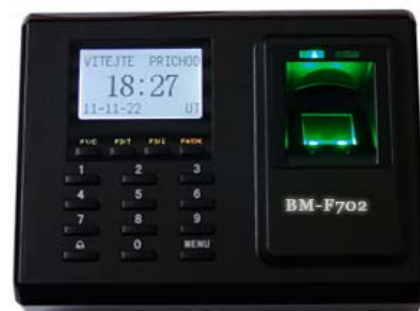
Terminál BM-F702 - příchod, odchod, 3 nebo 20 kódů přerušení a absencí, typy práce, otevírání dveří .
